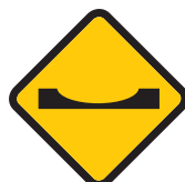
P.11 (b) Perfil Irregular (badén)
